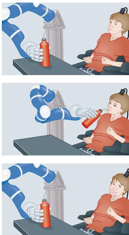
**图 39.3.3:** 一名瘫痪的受试者使用机械臂从瓶子里喝水，机械臂由使用连续解码器的运动脑机接口控制。第一次成功试验的三张连续图像显示，受试者使用机械臂抓住瓶子，把它放到嘴里，用吸管喝咖啡，然后把瓶子放回桌子上<sup>[377]</sup>。
